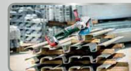
11 Trennschnitte von Leitplanken Material: Stahlblech
